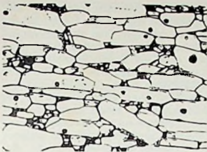
Bild 16. Horizontale magnetische Vorzugsrichtung der Einbereichsteilchen beim Bariumferrit
